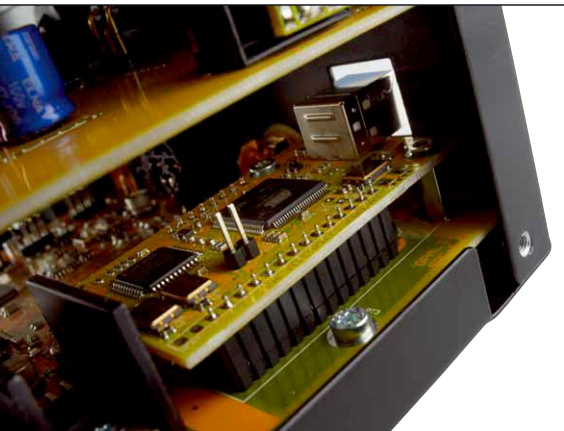
Das für die Signalverarbeitung verantwortliche Board wird von einem separaten analogen Netzteil versorgt
